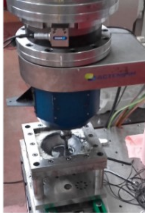
SPIF on ABB IRB 8700 robot
